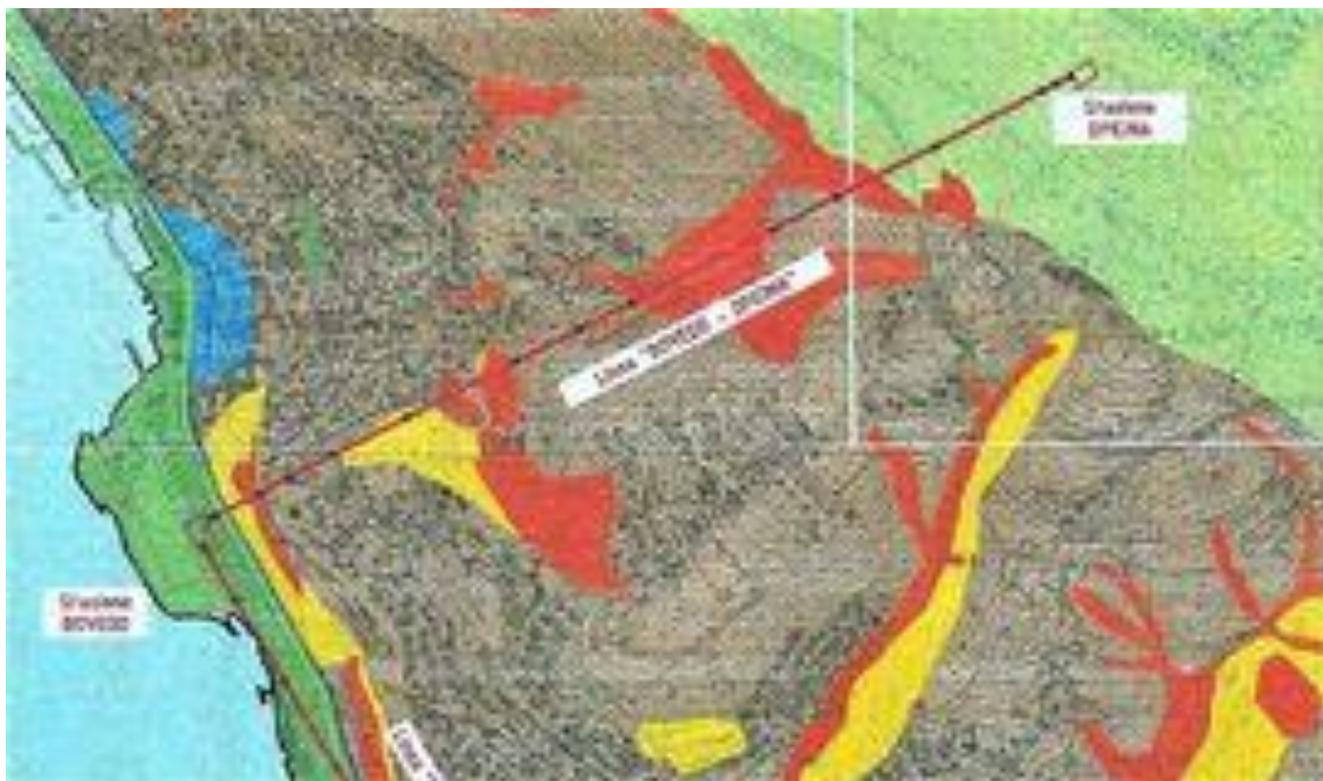
Sovrapposizione tracciato ovovia su carta di zonizzazione geologica – tecnica in cui si evidenzia chiaramente la sistemazione di almeno un pilone in zona ZG1, inedificabile geologicamente e di altri al limite delle zone denominate ZG1.
